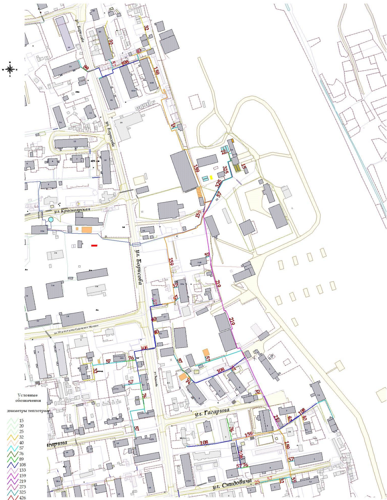
Рисунок 3 – Схема тепловых сетей ЦТП «Аэропорт»
