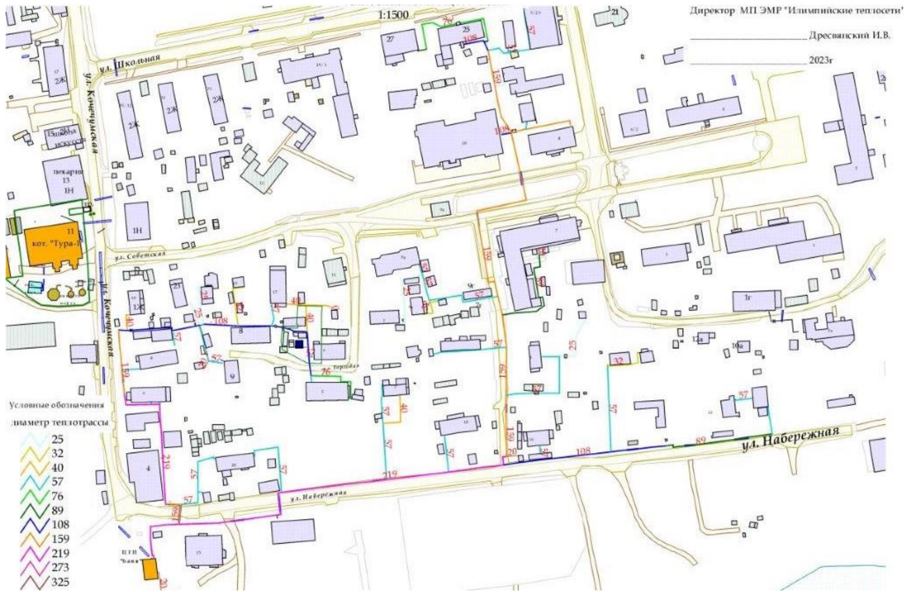
Рисунок 16 – Схема тепловых сетей ЦТП «Баня»
