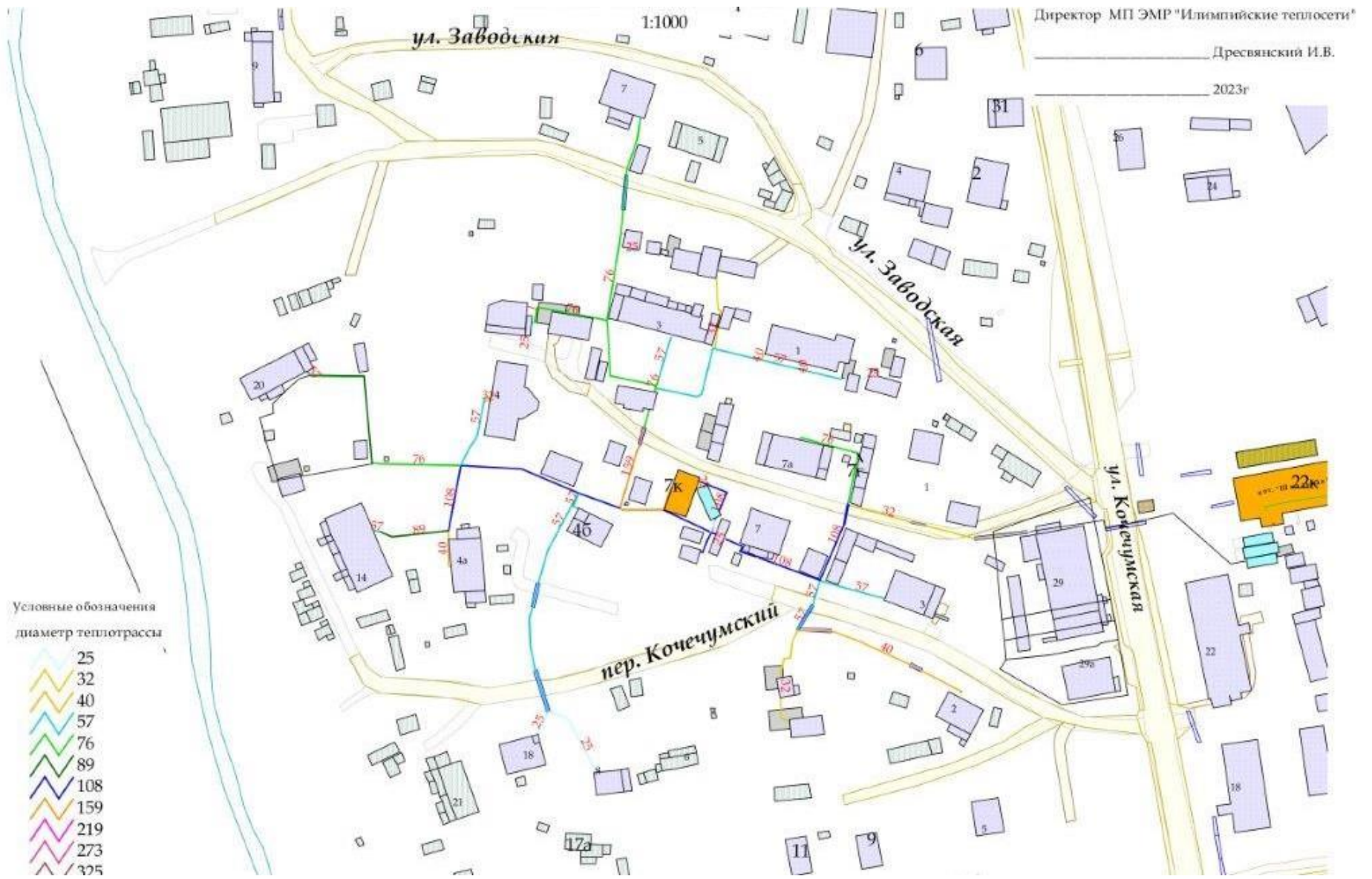
Рисунок 9 – Схема тепловых сетей котельной «Наркология»
