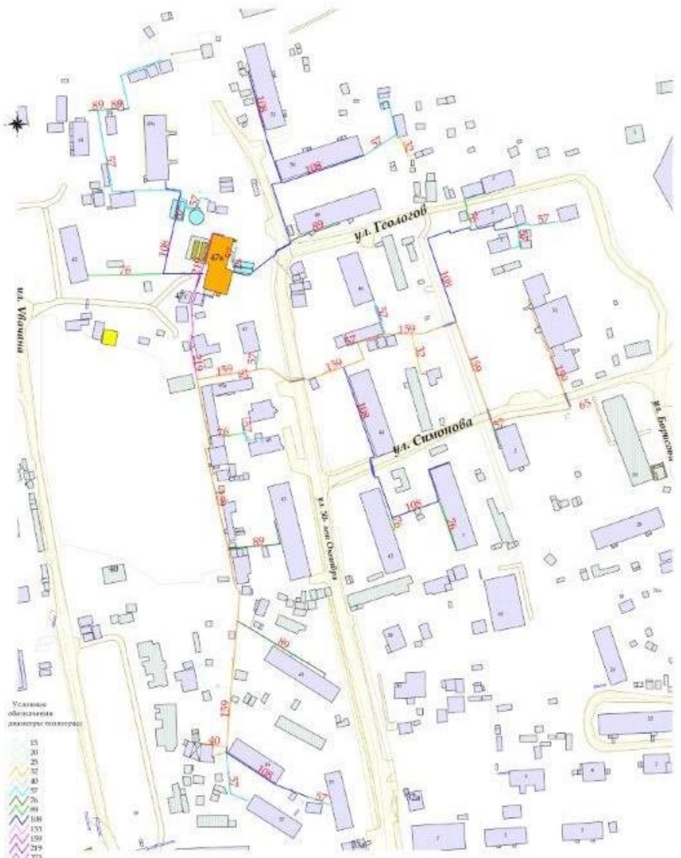
Рисунок 6 – Схема тепловых сетей котельной «ТРСА»
